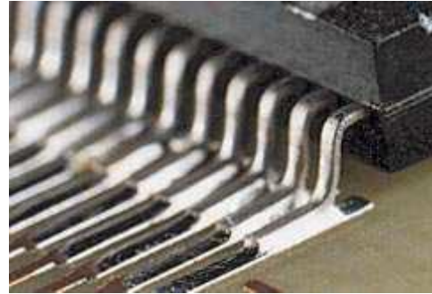
7.8. ábra: Ideálisan beültetett és forrasztott sirálszárny kivezetésekkel rendelkező IC
