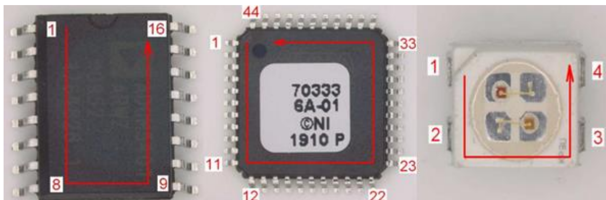
2.10. ábra: Integrált áramkör lábkiosztása
