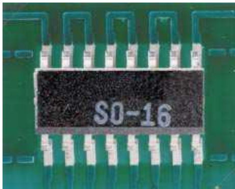
7.9. ábra: Megengedett mértékben félrehelyezett sirálszárny kivezetésekkel rendelkező IC
