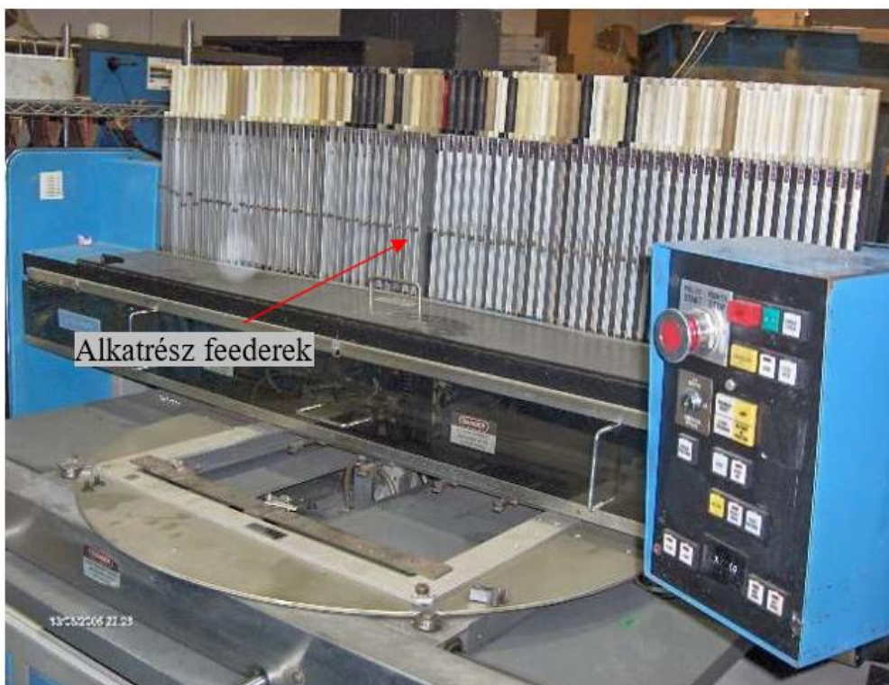
3.11. ábra: DIP tokozású alkatrészek beültetésére szolgáló automata berendezés
