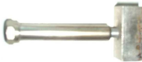
5.25. ábra: Forrasztópákához való IC tok kiforrasztó fej
