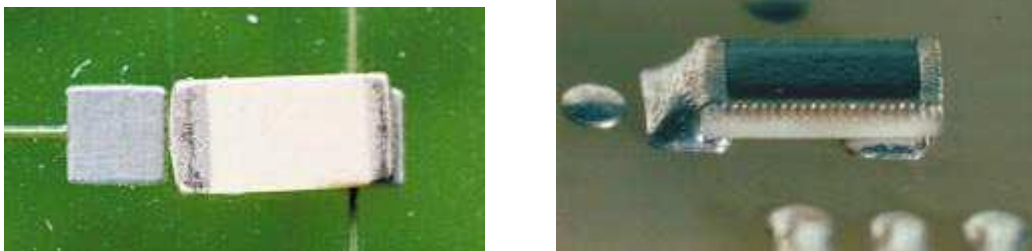
7.4. ábra: Hosszirányban félrehelyezett chip méretű, felületszerelt alkatrészek
