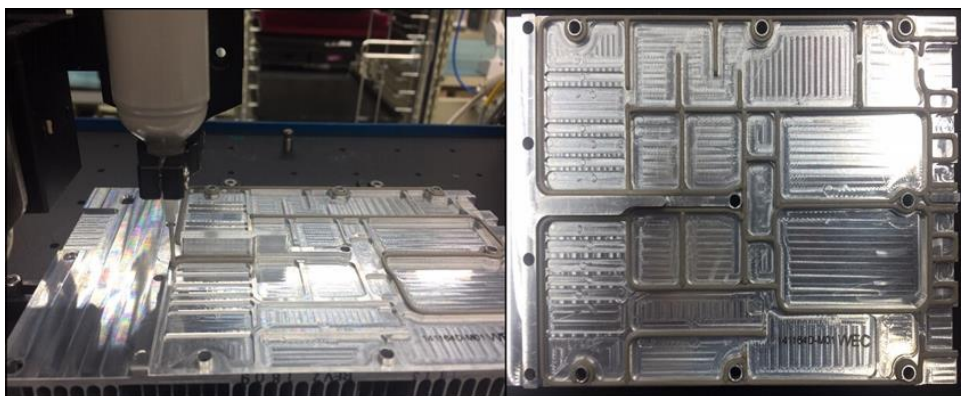
6.18. ábra. Gasketing adagolási folyamata, és elkészült lenyomat
