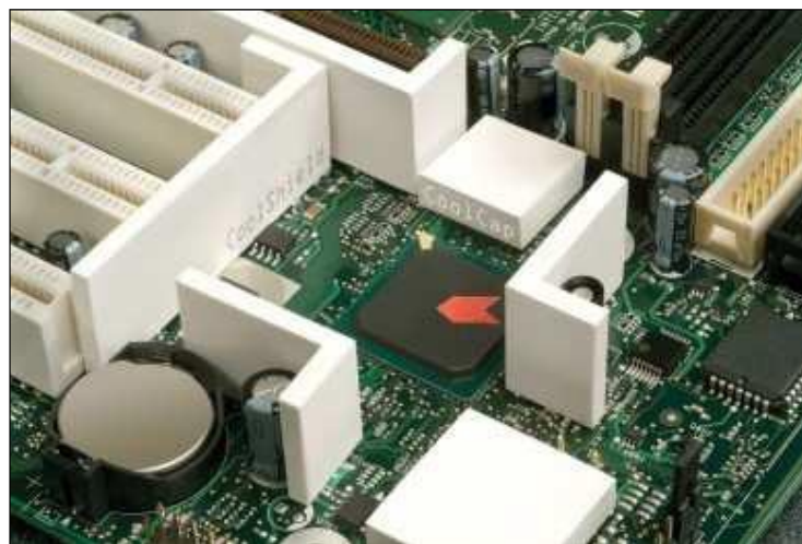
5.28. ábra: Hőterhelés csökkentése hőszigetelő elemekkel
