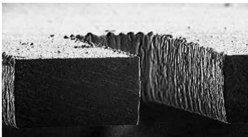
4.10. ábra: Lézerrel vágott stencil apertúra
