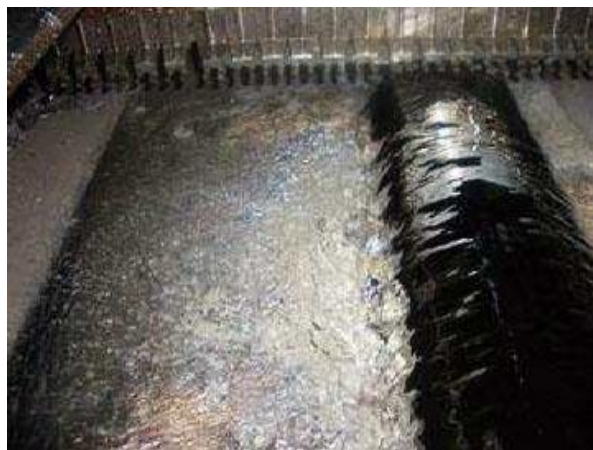
3.23. ábra. Összefüggő salakréteg a forraszkádban
