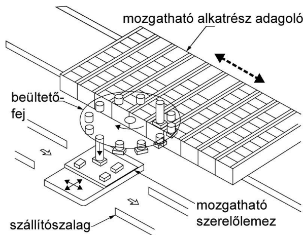
4.44. ábra: Mozgótálcás beültető gép rendszervázlata
