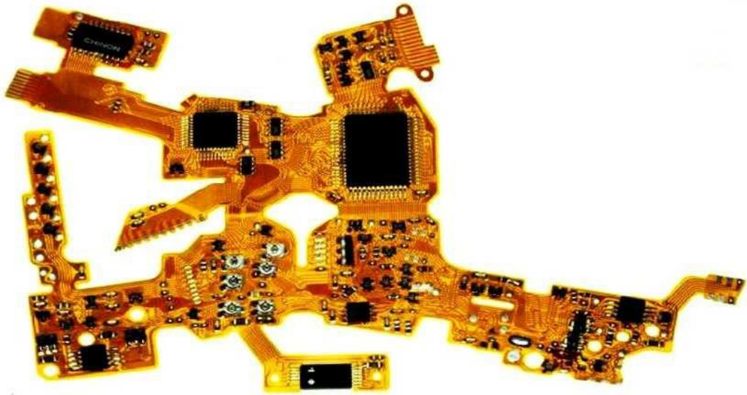
2.14. ábra: Hajlékony nyomtatott huzalozású hordozó
