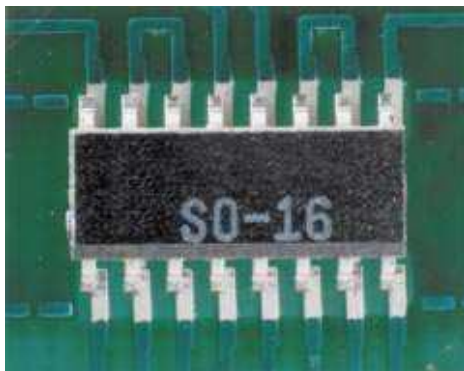
7.10. ábra: Nem megengedett mértékben félrehelyezett sirálszárny kivezetésekkel rendelkező IC
