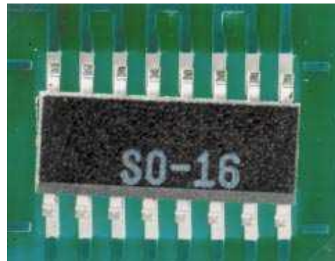
7.9. ábra: Megengedett mértékben félrehelyezett sirálszárny kivezetésekkel rendelkező IC
