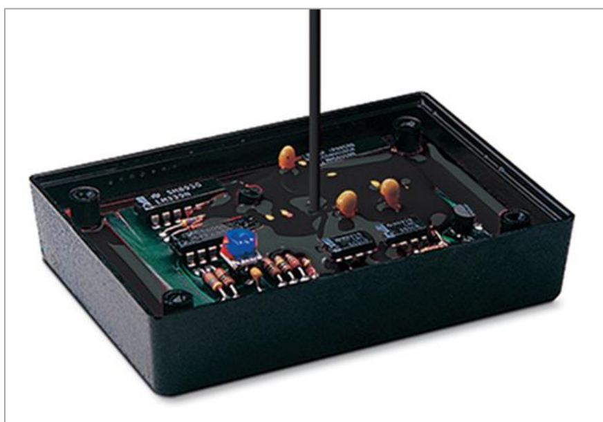
6.26. ábra. A potting folyamata
