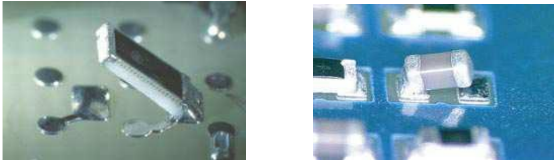
7.5. ábra: Sűrű effektus chip méretű, felületszerelt alkatrészeknél
