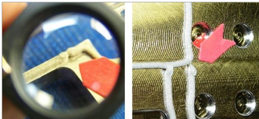
6.25. ábra. A megszakított adagolás különböző fajtái
