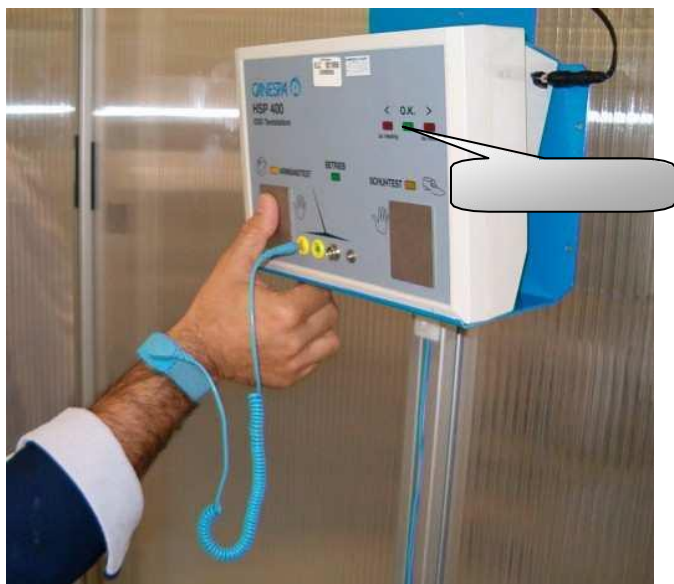
7.47. ábra: ESD védelmi felszerelések helyes használata: a.) csuklópánt, b.) sarkantyú
