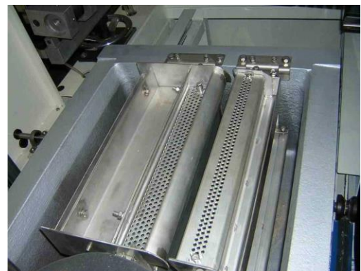
b.) A kettős hullámot létrehozó fűvókarendszer
