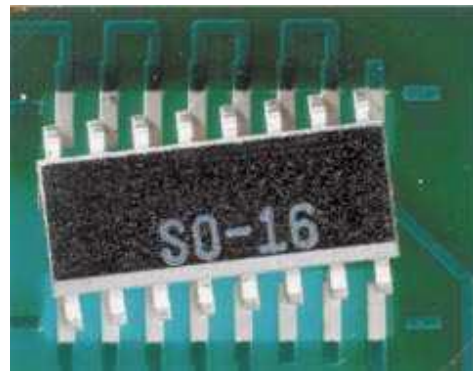
7.10. ábra: Nem megengedett mértékben félrehelyezett sirálszárny kivezetésekkel rendelkező IC
