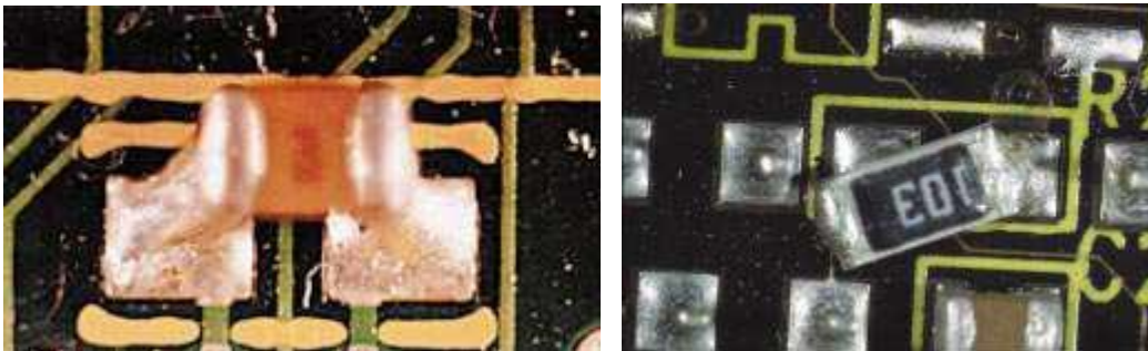
7.3. ábra: Oldalirányban félrehelyezett chip méretű, felületszerelt alkatrészek
